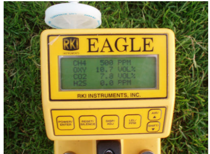
Bodenluft (verdichteter Boden) < 10 % O 2 , > 5% CO 2 , Methan (CH 4 ) oder Schwefelwasserstoff (H 2 S) > 50 ppm
