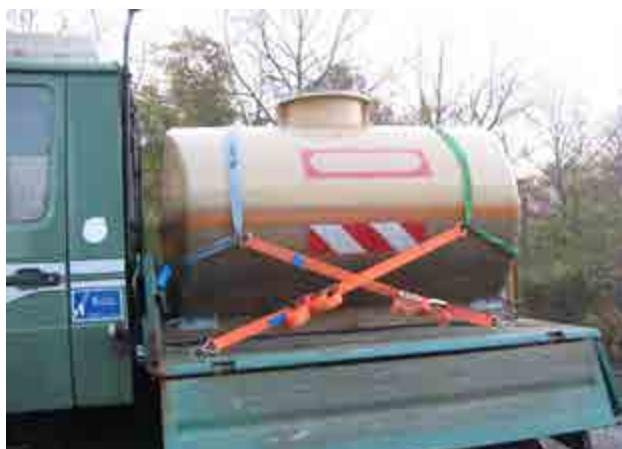
Abb. 161 Formslüssige Ladungssicherung eines Tankes
