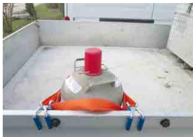
Abb. 162 Sicherung einer Flüssiggasflasche mit Umreifungsgurt und Bordwandkrallen
