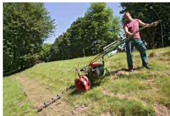
Abb. 56 Mähbalken mit Gitterräder
