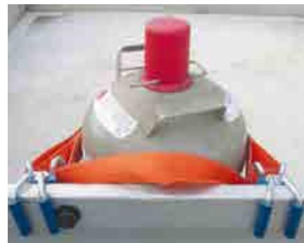
Abb. 145 Ordnungsgemäß gesicherte Flüssigasflasche mit Ventilschutzkappe
