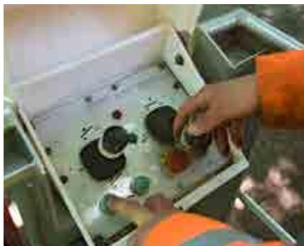
Abb. 118 Steuerpult Hubarbeitsbühne im Korb
