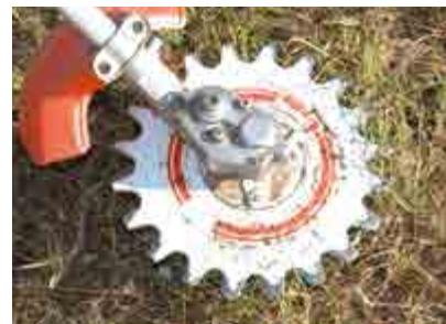
Abb. 61 Zweiseibenschneidwerk (Scherenprinzip)
