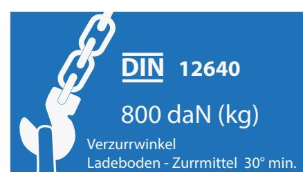
Abb. 159 Kennzeichnung eines Zurrpunktes
