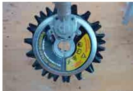
Abb. 60 Zweiseibenschneidwerk (Rotationsprinzip)
