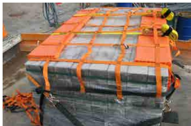
Abb. 166 Ladungssicherungsnetz
