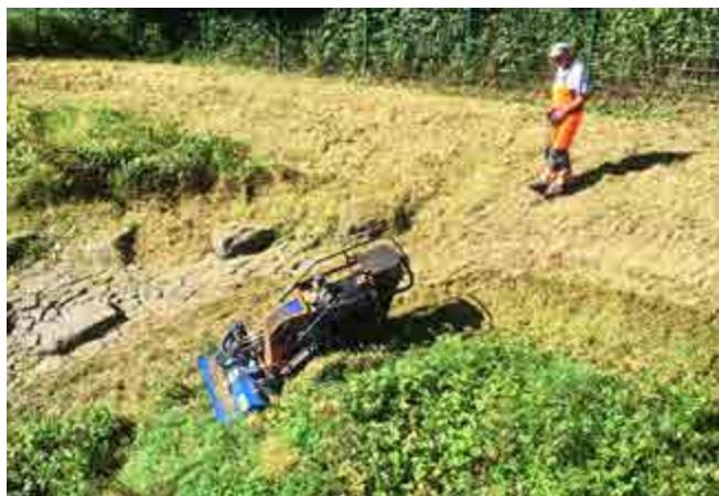
Abb. 51 Ferngesteuertes Mähergerät am Hang
