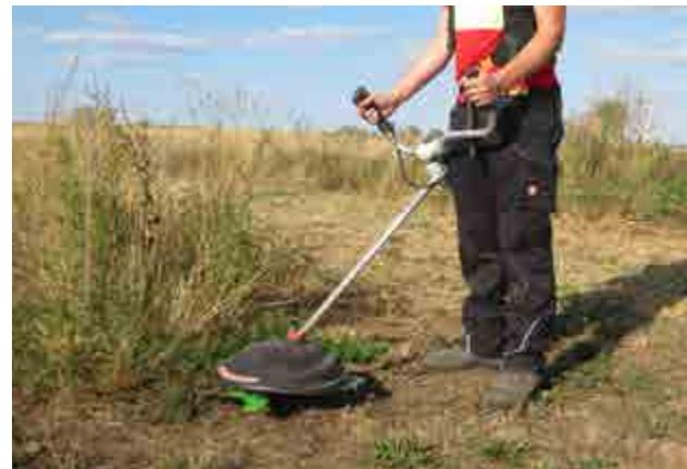
Abb. 58 Luftkissenprinzip und spezielle Schutzaube
