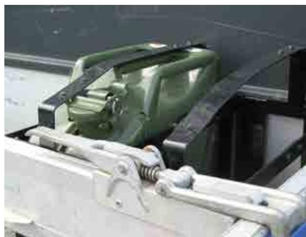
Abb. 164 Sicherung von Kraftstoffbehältnissen durch Formschluss
