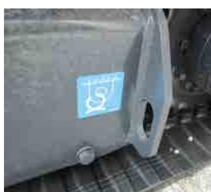
Abb. 158 Zurrpunkt an einer Maschine
