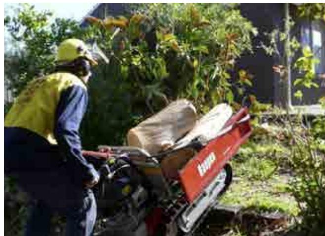
Abb. 152 Mini-Dumper/Motorschubkarre für ergonomischen Materialtransport im Gelände
