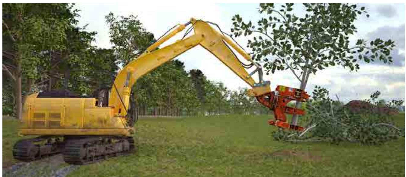
Abb. 110 Trägerfahrzeug mit Baumschere
