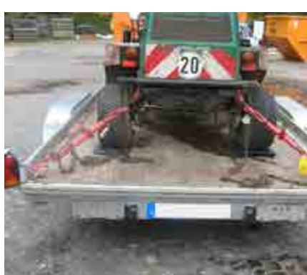
Abb. 157 Sicherung durch Direktzurren
