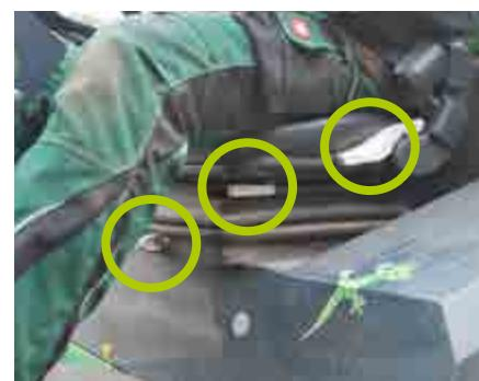
Abb. 41 Einstellbarer schwingungs gedämpfter Fahrersitz
