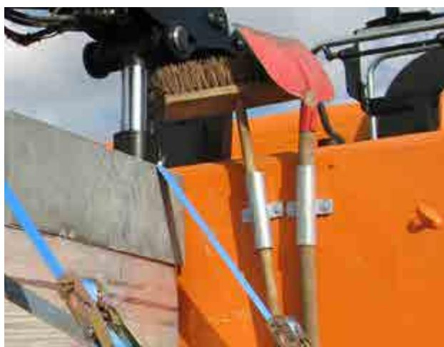
Abb. 163 Formslüssige Sicherung von Besen und Schaufel an einer Pritschenstirnwand
