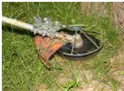
Abb. 59 Graschneideblatt mit Kanten- und Rindenschutz
