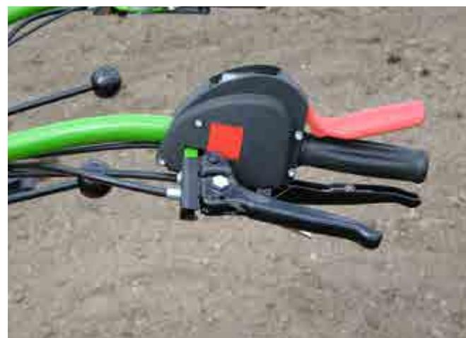
Abb. 23 Bedienelemente an einem Einachs-Schlepper
