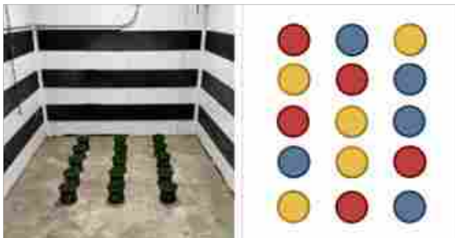
Abb. 5: Versuchstöpfe in der Klimakammer und randomisierte Anordnung der Töpfe: blau = Spindelmäher, rot = Sichelmäher und gelb = Akku-Handschere. (Foto: L. Ellmers)
