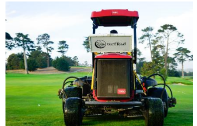
Die Sensoren von TerraRad sind flexibel in der Handhabung und können ohne aufwendige Montage schnell auf eine andere Toro-Maschine umgesetzt werden.
