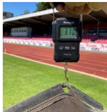
Abb. 6: Bestimmung des Gewichts des Striegelguts mit einer Kofferwaage. (Foto: M. Schwalm)
