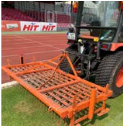
Abb. 4: Schleppergezogener Anbaustriegel. (Foto: M. Schwalm)
