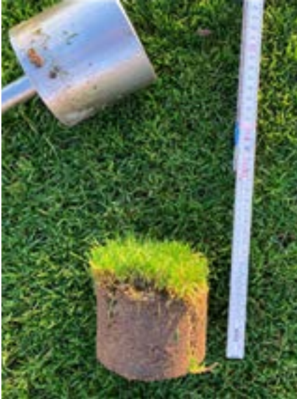
Abb. 7: Messung der Filzdicke mit Locher- sen und Meterstab. (Foto: M. Schwalm)
