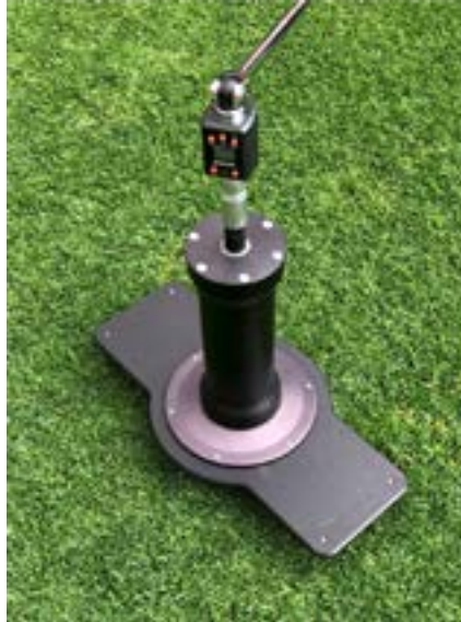
Abb. 8: Leichtes Drehwiderstandsgerät. (Foto: H. Nonn)
