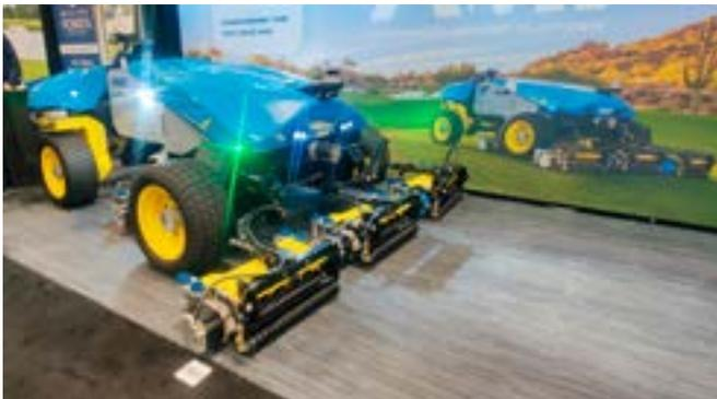
**Abb. 13: Interessant war dieser vollautonome Fairway-Mäher. Besonders hier: die über einen Riemen-Antrieb funktionierende Anhebung der Einheiten. Leider ist derzeit nicht geplant, eine EC-Zulassung zu beantragen, somit wird es die Maschine vorerst nicht in Europa geben.**
