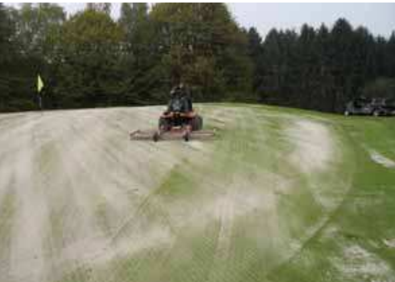
Kreativität bei der Arbeit: Zweckmäßiger Anbau mit Bürsten zum Besanden der Grüns
