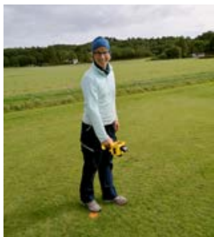
Abb. 1 a, b, c: Erfassung von Prüfparametern auf den Rasenparzellen: Einsatz eines Chlorophyll-Messgerätes, um die Vitalität des Bestandes zu prüfen (li.), Feuchtemessung mittels TDR (mi.), Registrierung von Deckungsgrad und Krankheitsbefall in den Sortenversuchen (re.).
