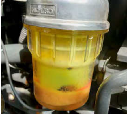
Klar zu erkennen: Feste Bestandteile im Diesel setzen sich ab und verstopfen in der Folge die Leitungen.
