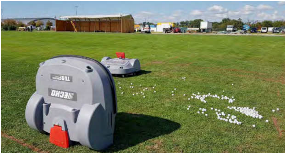
Der Mäher- und der Sammler-Roboter arbeiten rund um die Uhr, das entlastet das Personal und spart Kosten. (Alle Fotos: Golfkontor)
