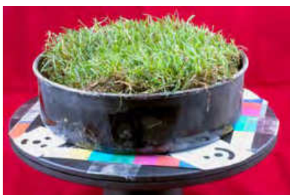
Abb. 4: Drehteller mit Fernsehtestbild, Referenzpunkten und Pflanzschale.
