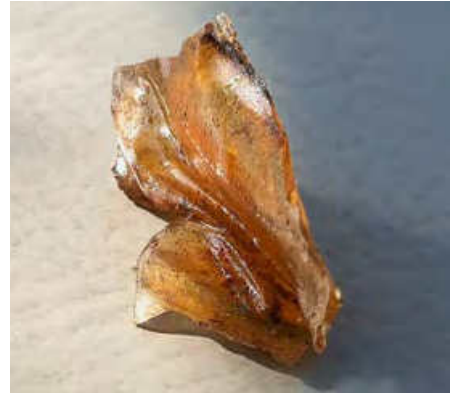
Verklumpte, ausgetrocknete und erhärtete Masse, die im Diesel gefunden wurde.
