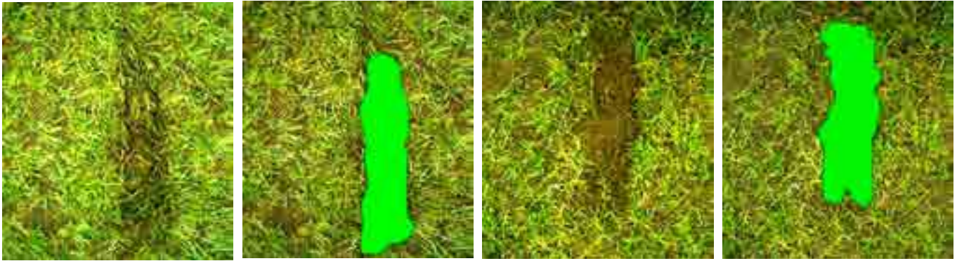
Abb. 7a, b, c, d: Divots in der Narbe einer Strapazierrasen-Versuchsfläche nach dem Einsatz des „Osnafoot“-Gerätes. Auswertung der Divot-Größe mit der Sigma-Scan-Methode (THIEME-HACK, 2018).
