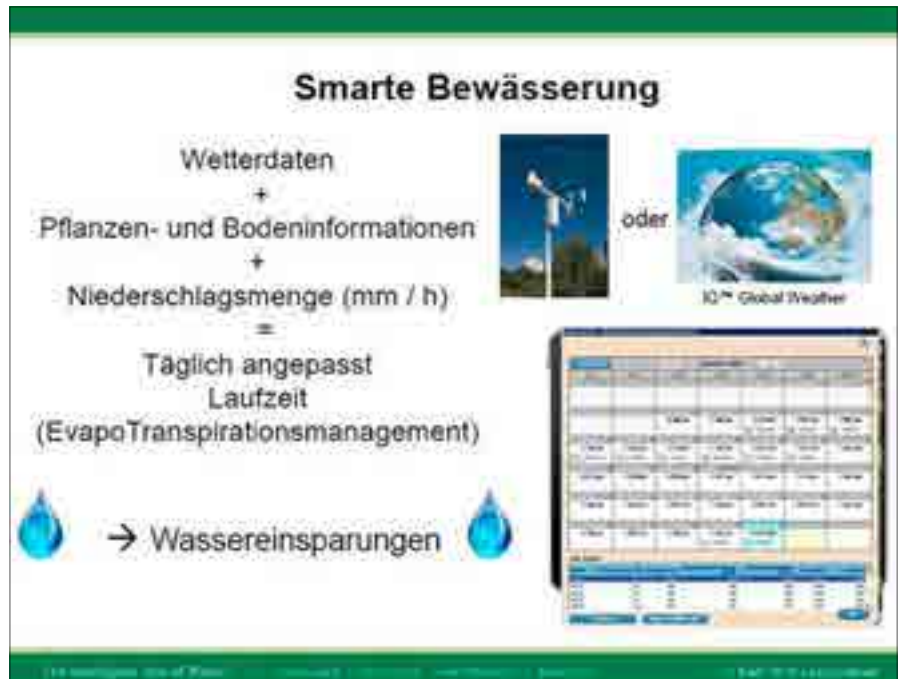
Abb. 11: Smarte Bewässerung berücksichtigt Wetter- und Bodendaten beim Beregnungsmanagement auf Basis der Evapotranspiration. (Quelle: Handout Björn Mühlbauer)
