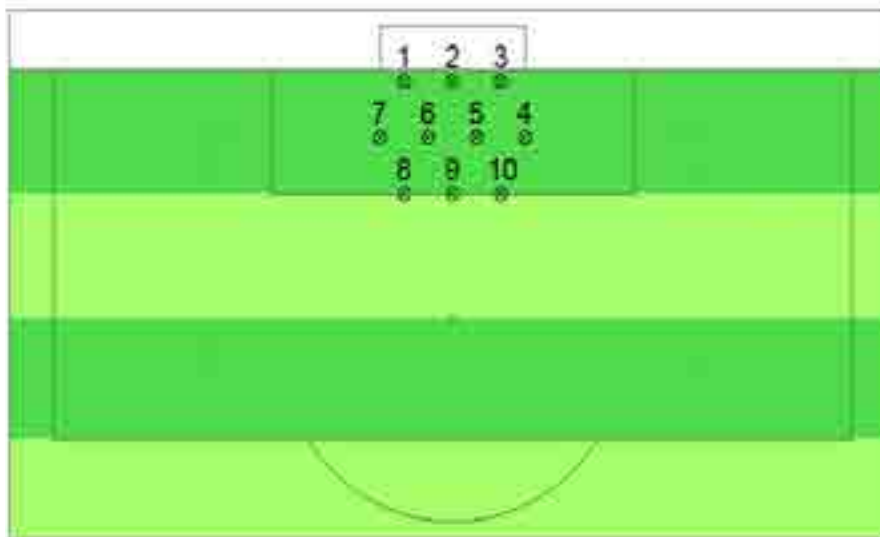
Abb. 8: Messpunkte Torräume für Bodenstärke und Bodenfeuchtigkeit.
