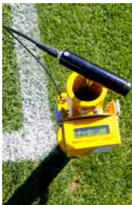
Abb. 6: Digitalanzeige des Clegghammers mit Messergebnis in Gm.
