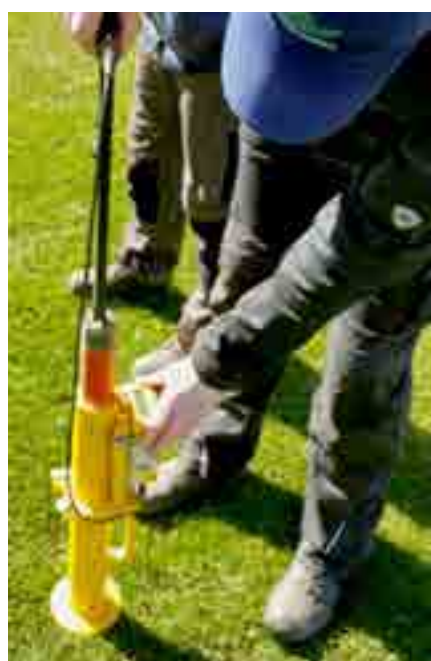
Abb. 5: Clegghammer bereit für die Messauslösung.
