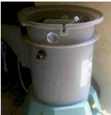
Abb. 1: Extraktionsbehälter zur Herstellung von Komposteluat
