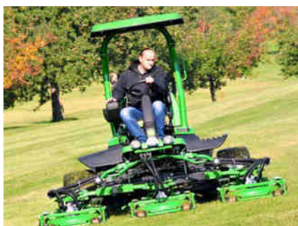
Abb. 5: Der neue John Deere Kontouren-Mäher 9009 A mit schnell zu verstellender Schnitthöhe an den Decks im Einsatz. (Foto: M. Sax)
