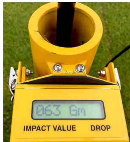
Foto 5: Digitale Anzeige und Speicherung des Messwertes bieten direkte Information und spätere Dokumentation.
