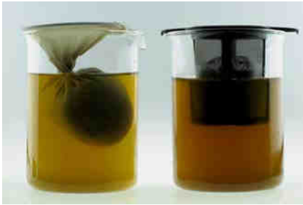
Abb. 5a: links das Eluat nach 24 h mit Beutel (etwas umgerührt). Abb. 5b: rechts das Eluat nach 24 h mit Sieb (etwas umgerührt).
