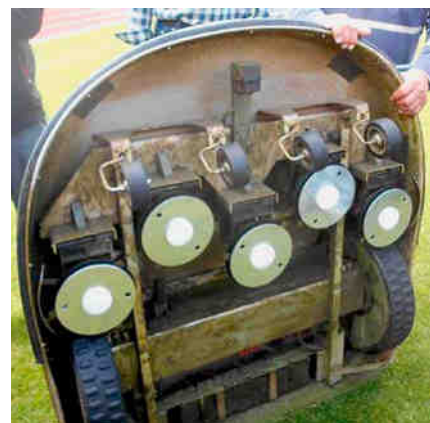
Abb. 7: Fünf Schneideinheiten mit je drei kleinen Messern arbeiten unter dem Mähroboter. (Foto: M. Bocksch)
