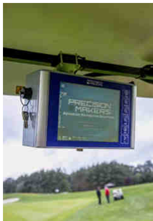
Das Display der autonomen Steuerung zeigt die Mähwege und Begrenzungen übersichtlich an.
