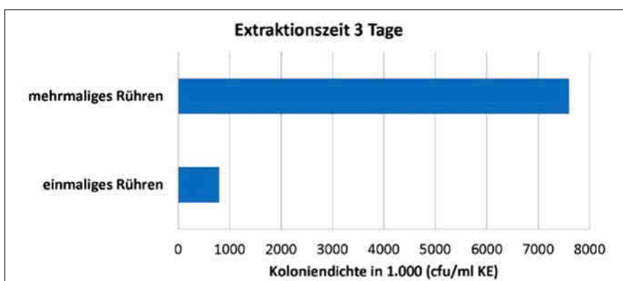
Abb. 4: Abhängigkeit der Ausbeute an Mikroorganismen von der Häufigkeit des Rührens (PAPAGEORGIOU et al., 2002)
