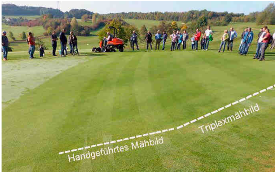
Abb. 4: Der vollelektrische Grünsmäher JACOBSEN Eclipse 322 im Einsatz. Da bei diesem Mäher die mittlere Einheit abschaltbar ist, kann ein Mähbild wie beim handgeführten Mäher erzeugt werden. (Foto: D. Kückens)
