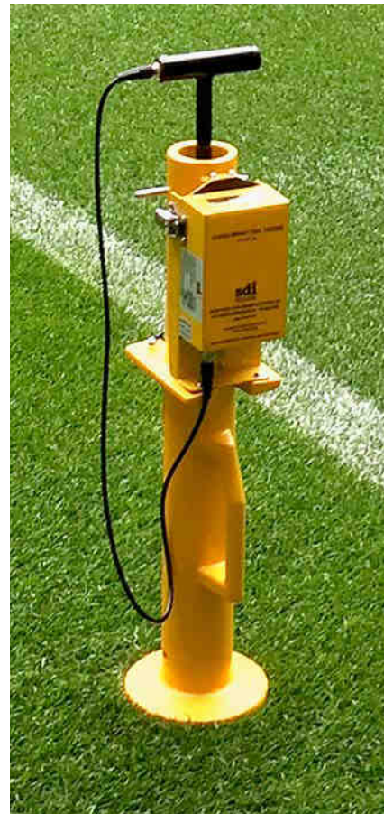
Foto 4: Clegghammer in Arbeitsposition auf einem Stadionrasen.
