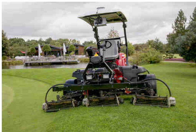
Der Reelmaster 5010-H, hier im autonomen Modus, in dem er einer vorgegebenen Route strikt folgt.
