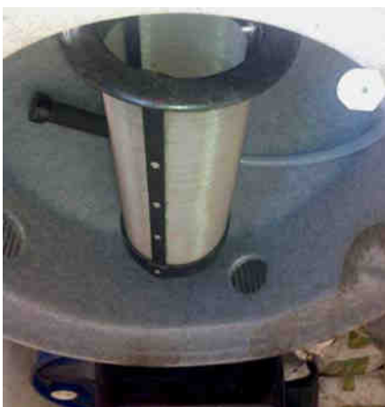
Abb. 2: Zylindrisches Sieb, in das das Kompostmaterial eingefüllt wird. Alternativ kann man einen mit Kompostmaterial gefüllten Gazebeutel in den Extraktionsbehälter hängen.
