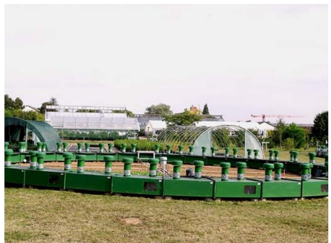
Abb. 6: FACE-Anlage an der Hochschule Geisenheim zur Erforschung der Auswirkungen erhöhter CO<sub>2</sub>-Konzentrationen auf die Entwicklung von Gemüseulturen.
