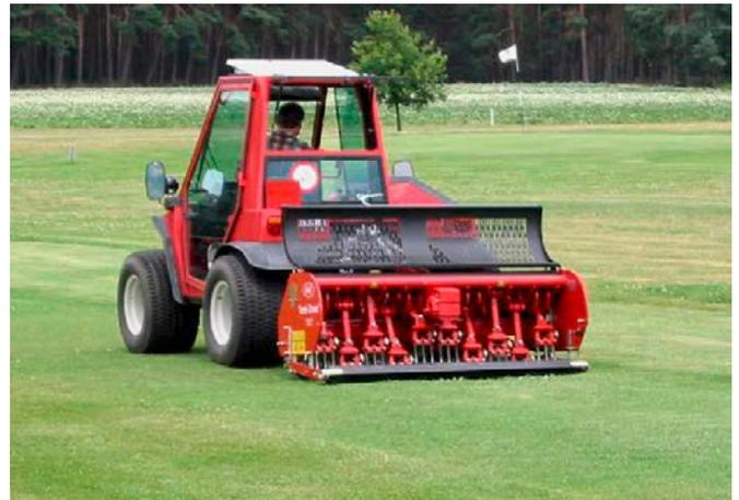
**Abb. 2: Traktor mit Tiefenlockerungsgerät.** (Foto: K.G. Müller-Beck)
