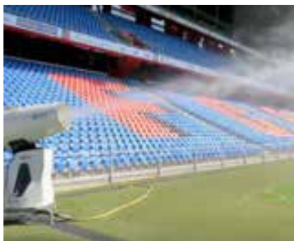
Abb. 4: Staubbindemaschine im Baseler „Joggeli“-Stadion zur Kühlung.
