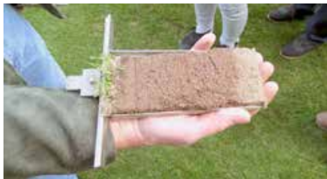
Abb. 3: Die neue Rasentragschicht im Baseler „Joggeli“-Stadion. Eine 10 cm dicke Mischung aus Lava, Rheinsand und Porolith hat das Drainverhalten des Spielfeldes deutlich verbessert.
