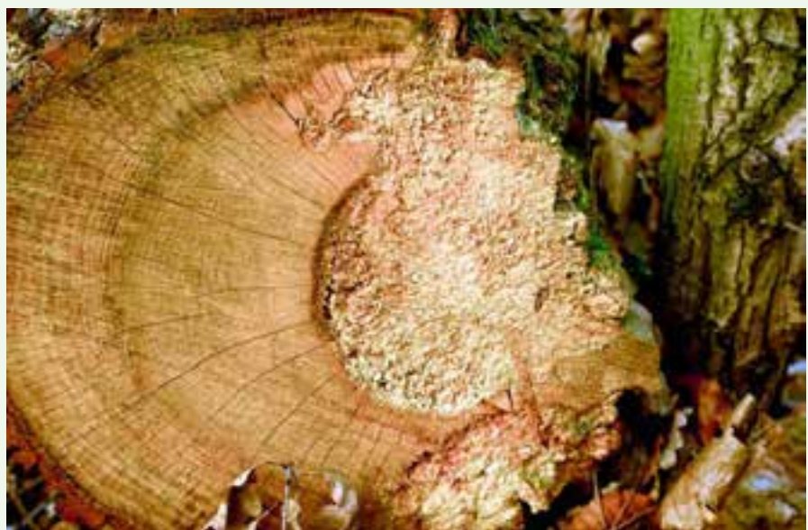
Abb. 9: Querschnitt durch einen Eichenstamm, bei dem sich große, durch den Eichen-Feuerschwamm durch Weißfäule geschädigte Kernholzbereiche deutlich vom gesunden Eichenholz unterscheiden; diese Partien sind bei der Eiche aber nicht weiß, sondern gelb gefärbt.
