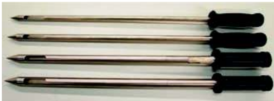
Nobbe – Probestecher (10, 12, 14 und 16 mm Innendurchmesser).
