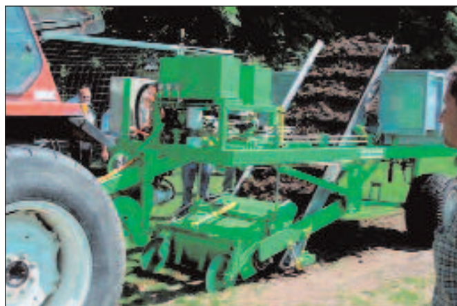
Ausfräsen schadhafter Rasenbereiche im Torraum Foto: Morhard
