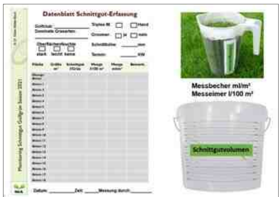
Abb. 2: Arbeitshilfsmittel zur Erfassung des Schnittgutvolumens, Datenblatt sowie Messbecher mit ml-Skalierung und Messeimer mit Liter-Skalierung. (Vorlage: K.G. Müller-Beck)
