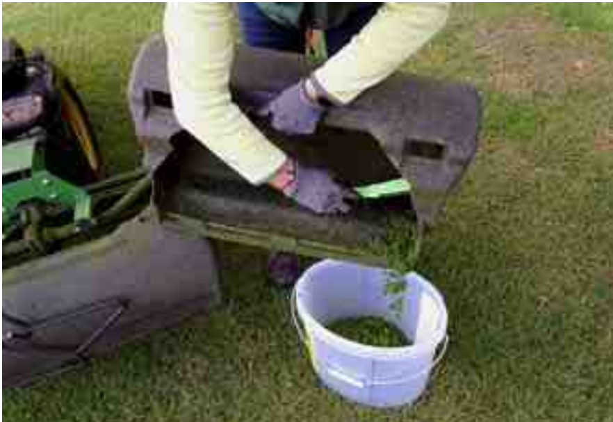
Abb. 3: Leerung der Fangkörbe in den Messbehälter (Skalierung in Liter) zur Ermittlung des Schnittgutvolumens je Grün. (Foto: K.G. Müller-Beck)
