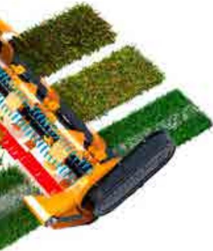
Distanzbuchsen anstelle der Schäkelmesser montiert. Dadurch ergibt sich ein Abstand von 25 mm zwischen den Messern auf der gesamten Arbeitsbreite. Durch die lose Aufhängung können die Messer Fremdkörpern wie beispielsweise Steinen ausweichen. Durch die mit 45 m/s rotierenden Messer wird die Filzschicht in der Wurzelhalszone gezielt zerschnitten und gelüftet, eine langfristig verbesserte Bodenstruktur ist die Folge.
