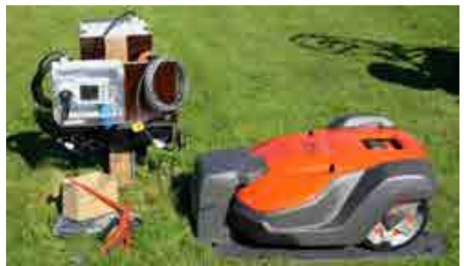
Abb. 2: An jeder Ladestation der Mähroboter ist ein Strommessgerät installiert, das den Energieverbrauch dokumentiert. (Foto: A.F. Borchert)
