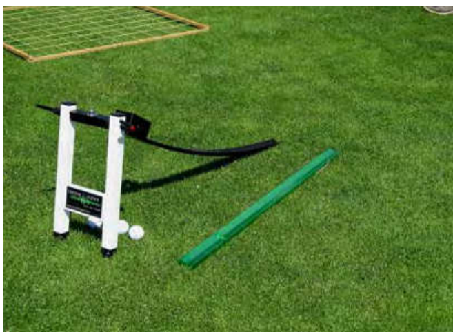
Abb. 1: Stimpmeter und Greens-Tester zur Bestimmung der Ballrolleigenschaften sowie Schätzrahmen zur Bestimmung der Narbendichte. (Alle Fotos: K.G. Müller-Beck)
