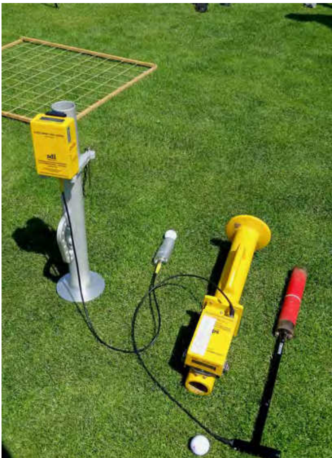
Abb. 5: Clegg-Hammer Golf mit 0,5 kg Fallgewicht abgerundet (li.) und Clegg-Hammer Sport mit 2,5 kg Fallgewicht (re.).
