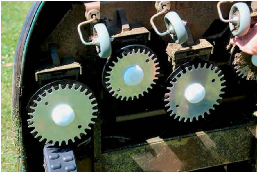
Abb. 3: Ballabweisender Schutz zur Vermeidung von Schäden an Golfbällen. (Foto: ILOS, 2019)
