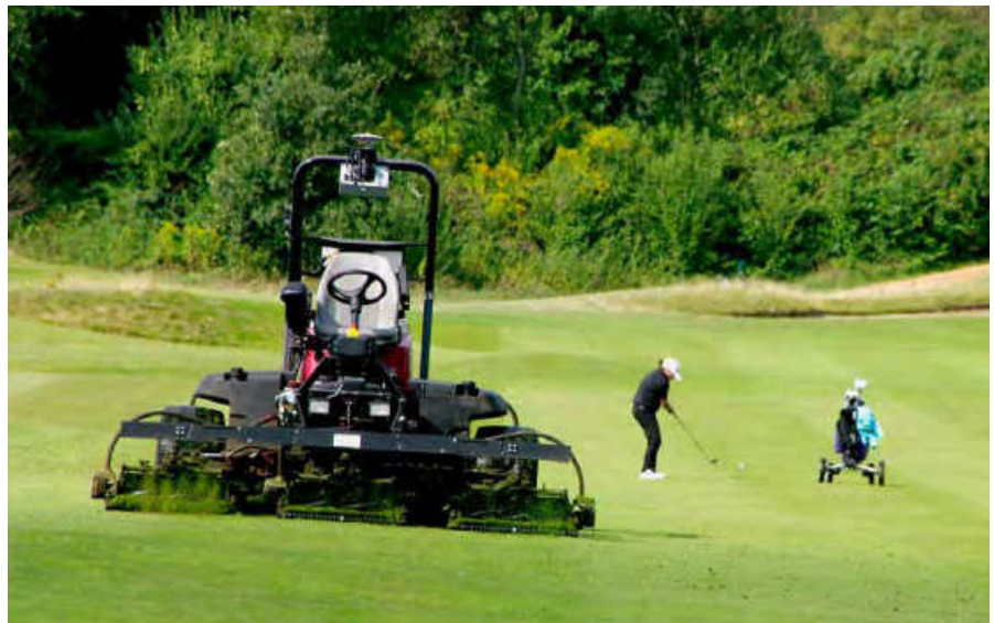
Abb.2: Professioneller Einsatz eines Fairwaymähers mit autonomer, georeferenzierter
