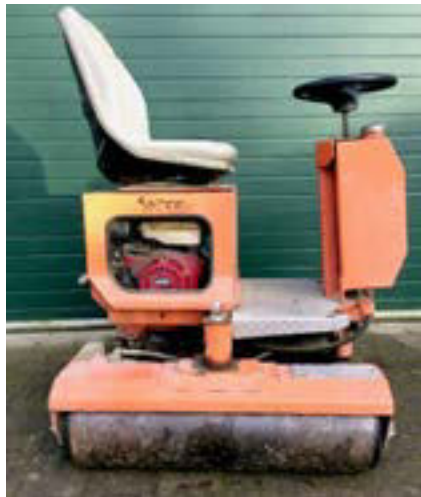
Abb. 1: Salsco-Walze, Arbeitsbreite 0,90 m, Gewicht 155 kg.
