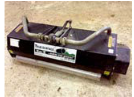
Abb. 2: Vibrationswalze, Arbeitsbreite 1,50 m.
