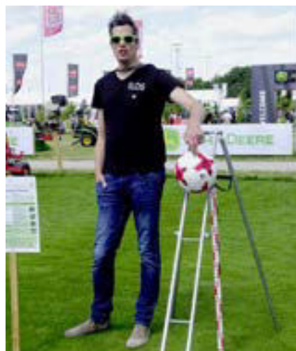
Abb. 6: Stativ mit Ausrollschiene zur Ermittlung der Ballroll-Strecke auf der Rasenflöäche.
