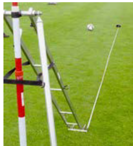
Abb. 7: Ballroll-Strecke von 5,75 m bei einer Starthöhe von 100 cm und einem Gefälle von 45°.
