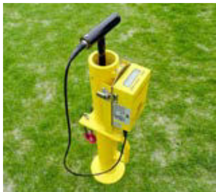
Abb. 5: Messung der Oberflöächenhärte mit dem Clegghammer (Clegg Impact Soil Tester).
