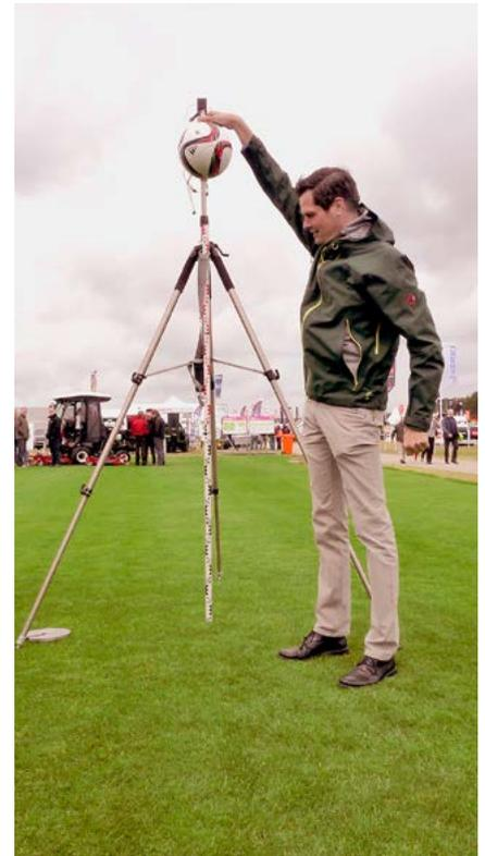
Abb. 2: Vertikaler Ball-Rückprall auf der Rasenfläche aus der definierten Fallhöhe von 2,0 m.
