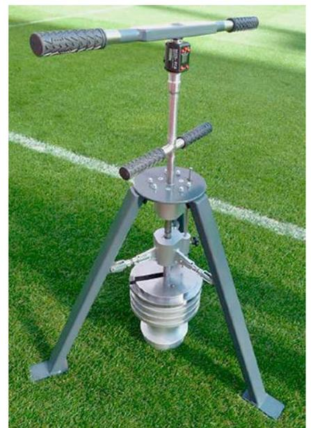
Abb. 7: Stollenschergerät zur Messung der Scherkräfte einer Rasennarbe in Newton Meter (NM).
