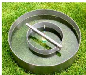
Abb. 2: Wasser-Infiltrationsrate gemessen mit Doppelring-Infiltrometer.
