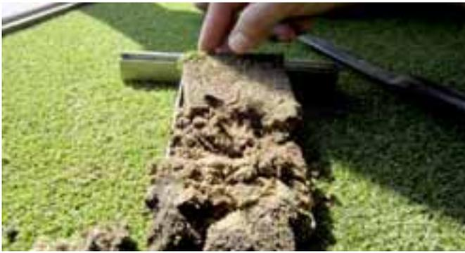
Abb. 5: Bestimmung eines Bodenprofils.
