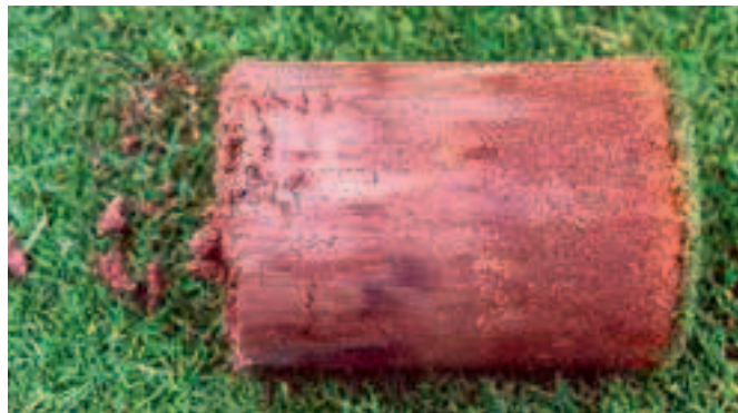
Ein Beispiel, wie es nicht aussehen sollte: Der Profilhorizont vor 15 Jahren zeigt die damals noch schwierigen Bodenverhältnisse. Heute sorgen etwa 20 cm Quarzsandhorizont für besseres Wurzelwachstum und vor allem hier in Schönenberg wichtig, mehr Fähigkeit, Wasser aufzunehmen.
