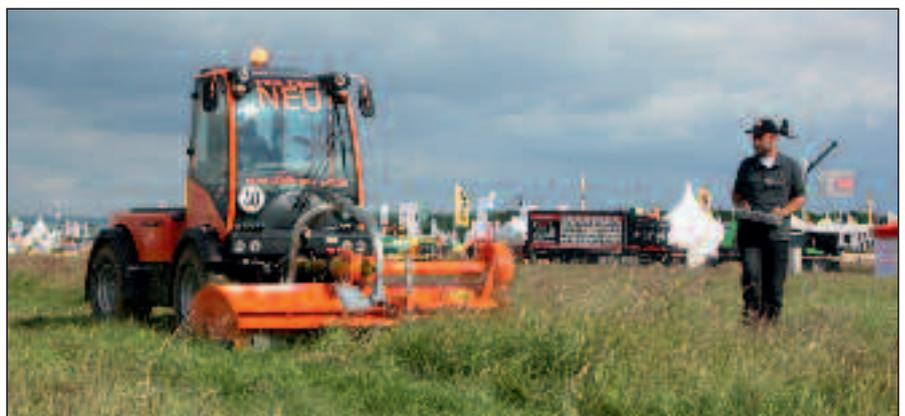
Abbildung 2: Holder M 480 funkferngesteuert mit Schlegelmulcher. (Foto: Max Holder GmbH)
