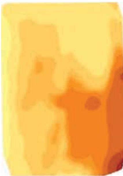
Abbildung 17: Darstellung der EM38-Daten eines Rasenspielfeldes mit Hilfe der lokalen polynomischen Interpolation
