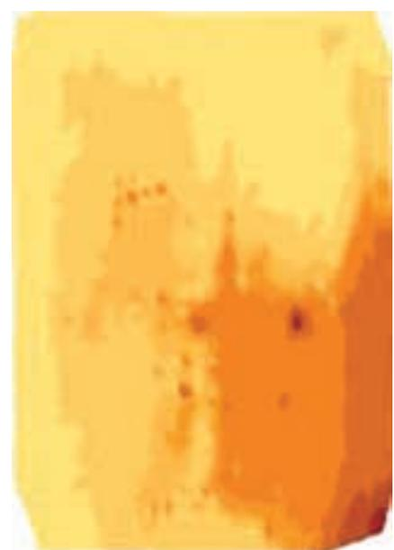
Abbildung 19: Darstellung der EM38-Daten eines Rasenspielfeldes mit Hilfe der Inversen Distanz Methode
