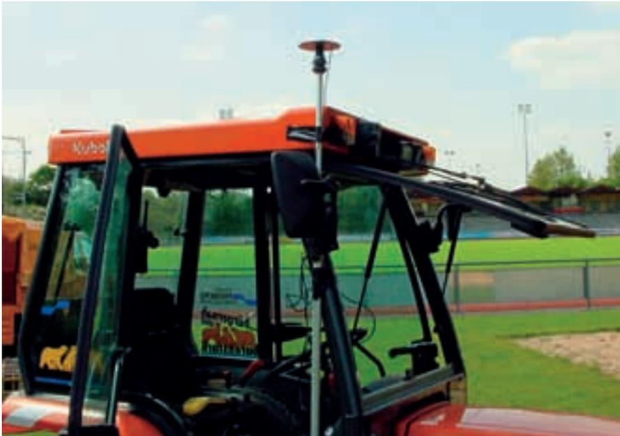
Abbildung 10: Roverantenne an Traktor bei kinematischen Messungen
