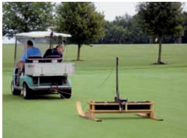
**Überprüfung der Wasserverteilung einer Beregnungsanlage in Sonnenbühl. Der Feuchtemess-Schlitten erfasst lückenlos den Feuchtegehalt des Bodens und gibt den Messwert über GPS zeitgleich in einen elektronischen Lageplan.**
