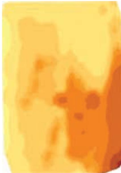
Abbildung 20: Darstellung der EM38-Daten eines Rasenspielfeldes mit Hilfe von Kriging
