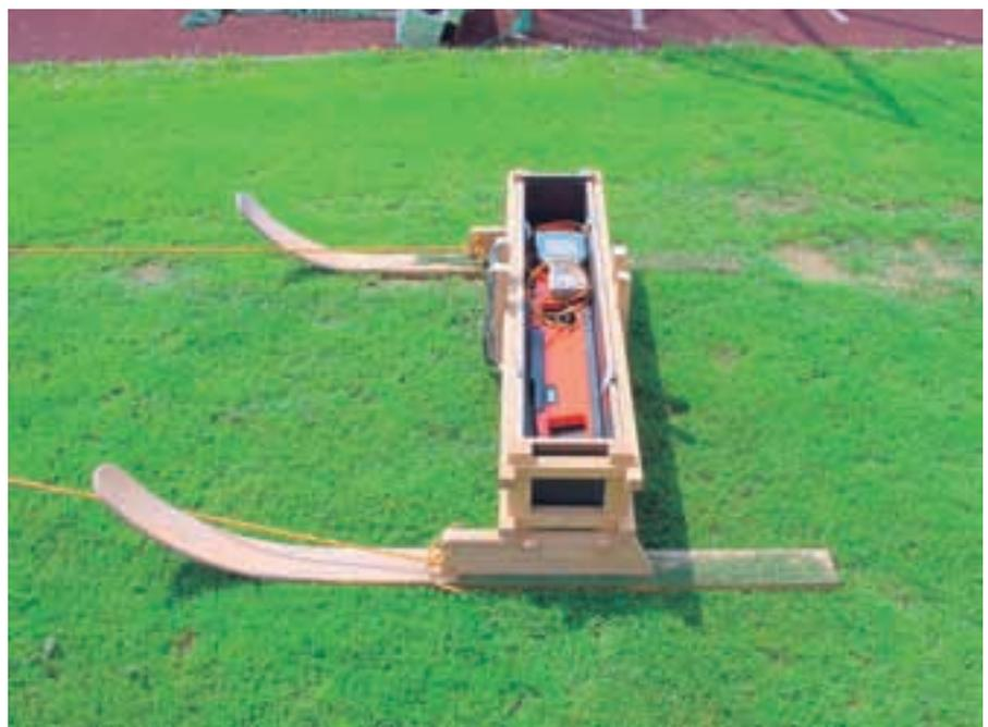
Abbildung 6: Versuchsschlitten mit eingesetztem EM38 im horizontalen Modus
