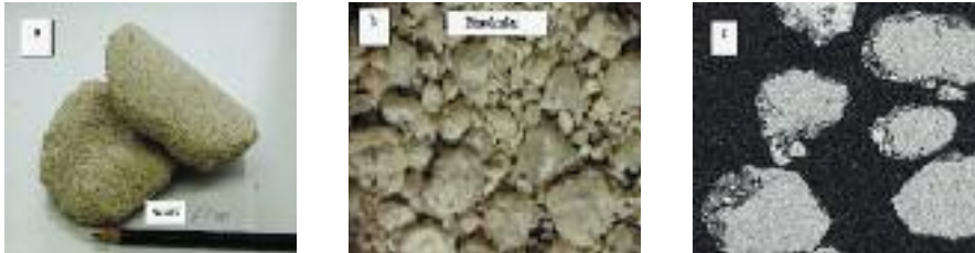
Abb. 1: Bildserien von Sand 2 und Sand 7 bei unterschiedlicher Vergrößerung. a) Das megaskopische Erscheinungsbild der Versuchsprobe; b) Das Bild eines Streupräparates unter dem Binokular bei 4-facher Vergrößerung; c) Das Bild eines Streupräparates im Elektronenmikroskop (s. Bildmaßstab).
