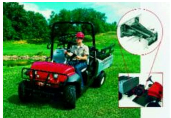
Die Fahrer des neuen Toro Workman bemerken sofort die sichere Fahrweise und hohe Traktionsfähigkeit des Gerätes. Das Toro exklusive „Twister“ Aufhängesystem erlaubt der Ladepritsche bei unebenem Gelände eine beidseitige Flexibilität bis 15 Grad. So bleiben das Fahrzeug und alle 4 Räder auch bei extrem unebenem Gelände immer in stabiler Bodenhaftung.
