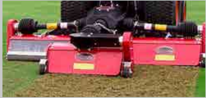
Vertikutier-Einheiten mit unterschiedlichen Arbeitstiefen.
