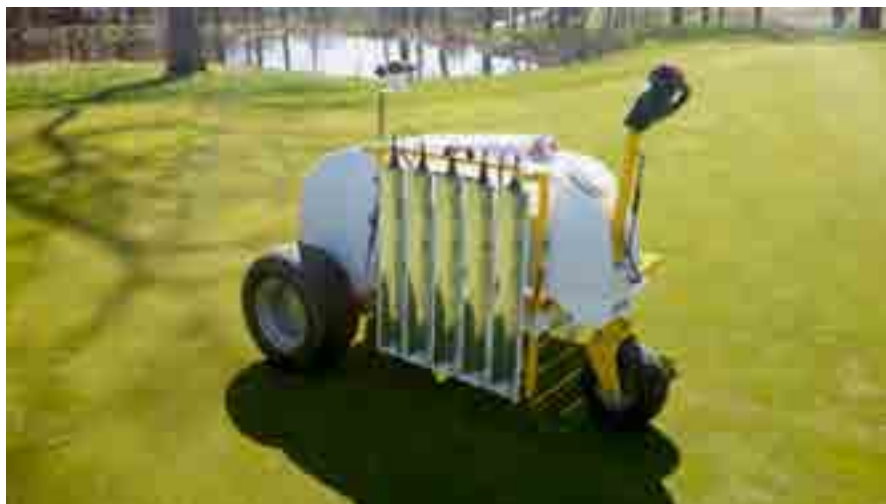
Abb. 1: UV-C-Behandlungsgerät zum Einsatz gegen Rasenkrankheiten auf einem Golfgrün. (Foto: W. Prämaßing)
