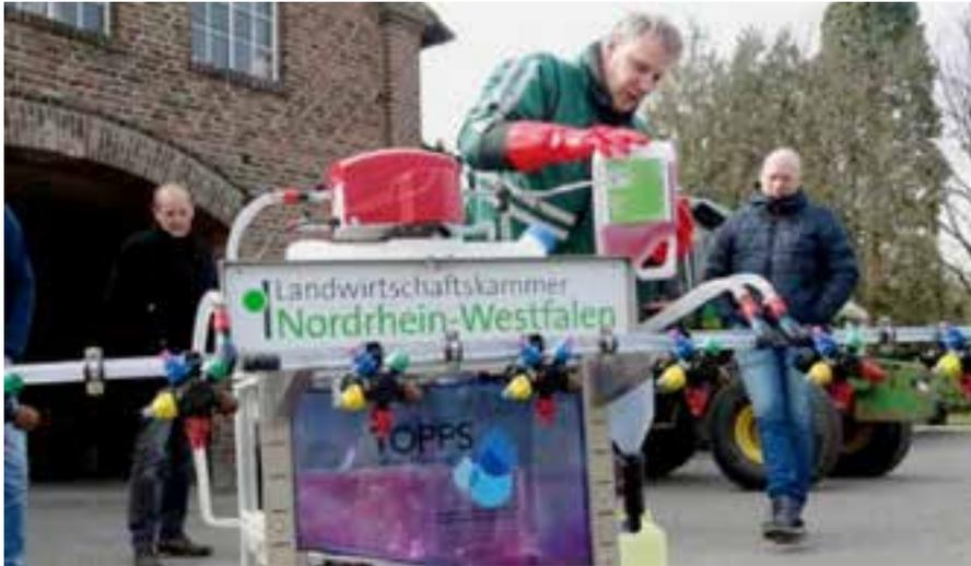
Abb. 2: Demonstration des geschlossenen Befüllsystems an der Spritze.
