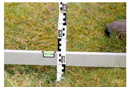
Abb. 2: Absackungen des Planums als Folge der unterirdischen Aktivitäten des Maulwurfs.
