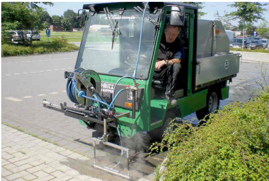
Abb. 4: Bekämpfung mit heißem Wasser, Gerät der Firma Empas
