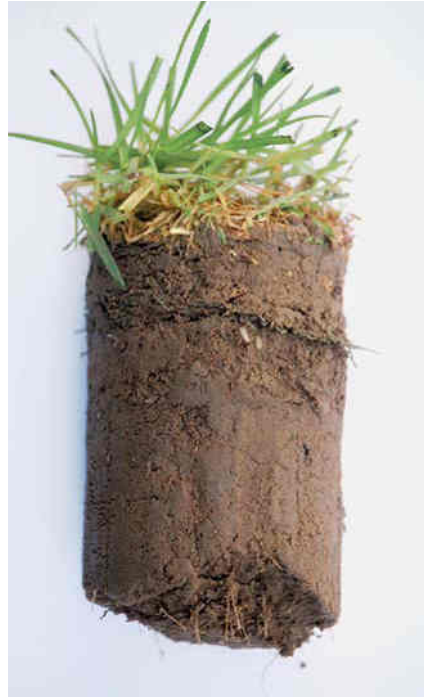
Abb. 5: In etwa 4 cm Tiefe eingebaute horizontale Maulwurfsbarriere.
