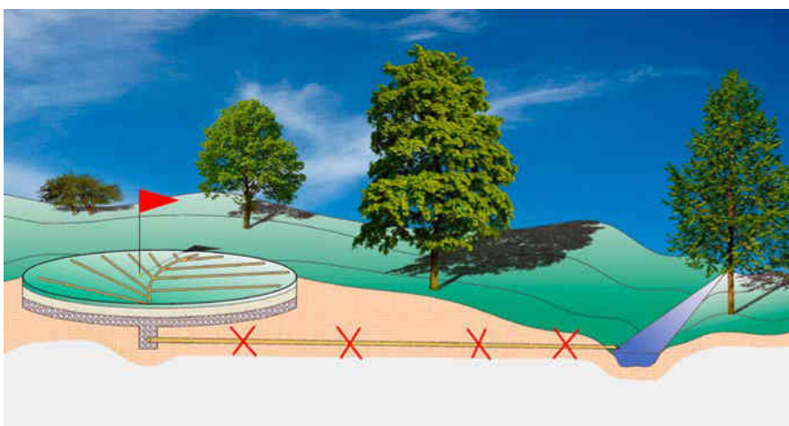
Abb. 1: Dränagen sollten nicht wie im Bild dargestellt in einen Entwässerungsgraben, sondern in eine Versickerungs- und Verdunstungsmulde geführt werden.
