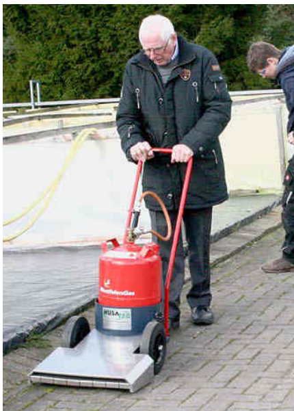
Abb. 2: Preisgünstige Technik: Abflamngerät der Firma Huisman (Foto: H. Beltz)
