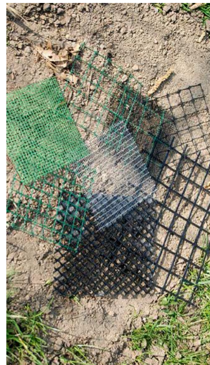
Abb. 3: Auswahl der im Handel angebotenen Materialien zur Ausgrenzung von grabenden Tieren.
