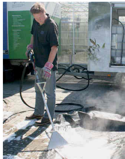
Abb. 5: Sicher für Nachbarpflanzen und entzündliche Materialien: Heißschaumgerät des Herstellers Ipros
