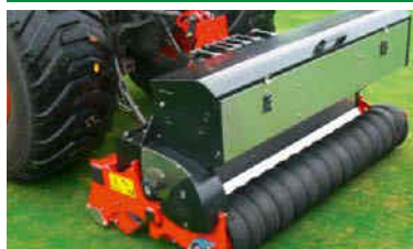
Rota Dairon mit gezahnten Schlitzscheiben, 140 cm und 200 cm.
