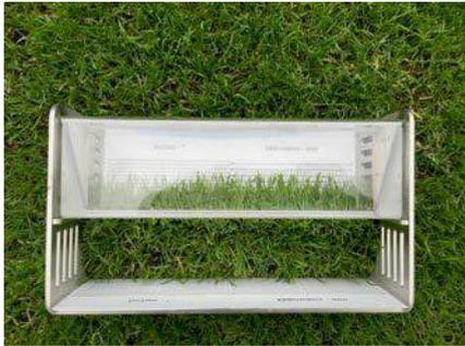
Abb. 7: Rasenprisma zur Bestimmung der Aufwuchshöhe.
