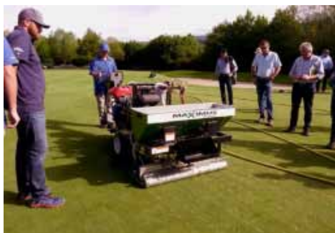
Abb. 8: Sandinjektion auf dem Golfgrün mit dem „DryJect-Gerät“. (Foto: K.G. Müller-Beck)
