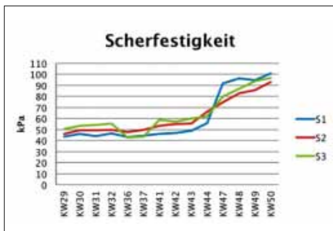
Abb. 1: Scherfestigkeitsverlauf der Versuchsflächen S 1 bis 3 in der BayArena.
