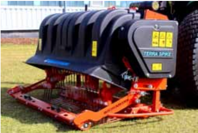
Leicht, kompakt und gründlich: Der neue Tiefenlockerer Terra Spike SL von Wiedenmann zur Belüftung empfindlicher Rasenflächen. (Fotos: Wiedenmann)
