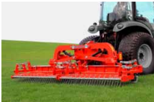
Die Maschinenserie Terra Rake bietet jetzt Arbeitsbreiten von 170 bis 460 cm. Im Bild das Modell mit 350 cm, die über zwei hydraulische Ausleger erzielt werden. Die kleineren Modelle sind einteilig konstruiert.
