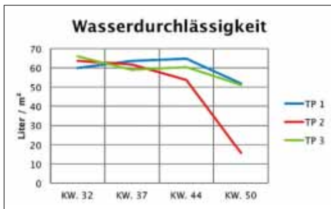
Abb. 11: Verlauf der Wasserdurchlässigkeits-Messungen auf dem Trainingsplatz 3.
