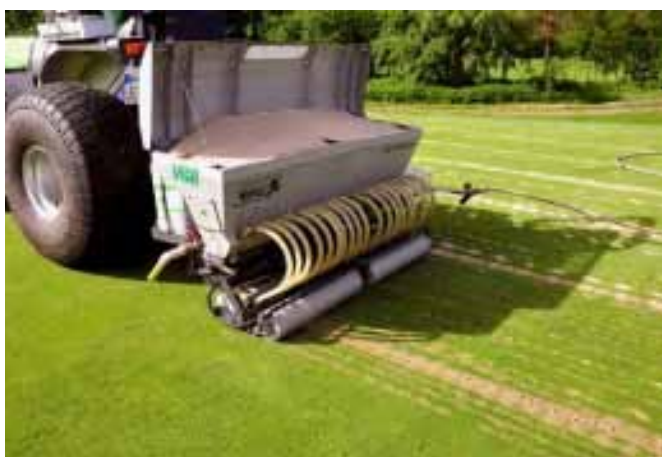
Abb. 7: Sandinjektion auf dem Golfgrün mit dem „Top Changer“. (Foto: M. Sax)
