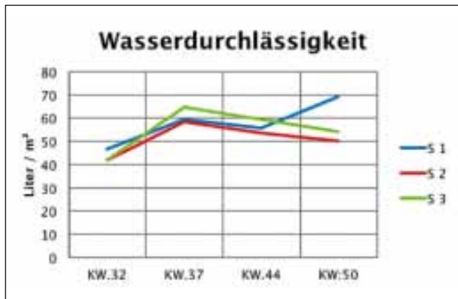
Abb. 9: Verlauf der Wasserdurchlässigkeits-Messungen in der BayArena.
