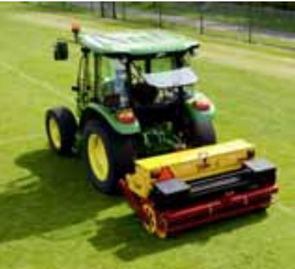
**Die Vredo 1,8 Meter SUPERcompact Durchsämmaschine in gezogener Ausführung.**
