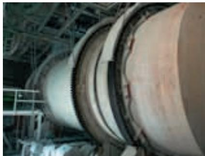
Abb. 2: Düngergranuliertrommel (Spherodizer) zur Herstellung von NPK-Mineraldüngern.
