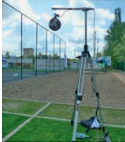
Abb. 6: Messung des Rückprallverhaltens eines Fußballs in Abhängigkeit von Boden- aufbau und Rasenqualität.
