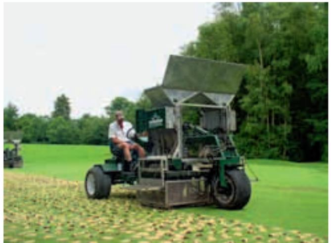
sofort mit Sand und einem Bodenverbesserer wie dem zeolithischen Sportslite von Ecosol verfüllt wird. Dadurch wird die Verdichtung aufgelockert und bessere Entwässerung ermöglicht, da Wasser die Kanäle heruntersickert, die monatelang offen bleiben und die Infiltrationsrate beschleunigen. Verfüllung kann je nach Rasenzustand exakt auf jede Grünfläche abgestimmt werden, um einen Bodenaustausch gegen Sand, zeolithische oder keramische Verbesserer und Nährstoffgemische herbei-
