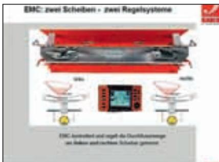
Im EMC-System misst modernste Sensortechnik im Hydrauliksystem das Antriebsdrehmoment der Wurfscheiben und regelt die Durchflussmenge.
