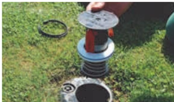
Das Auswechseln eines Regners ist in weniger als einer Minute und ohne Fachkenntnisse möglich. Das Umrüsten einer 18-Loch-Anlage ist somit an nur einem Vormittag zu erledigen.
