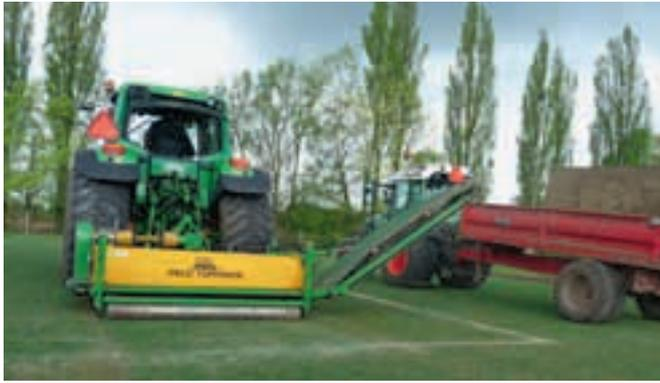
Abb. 9: Praktischer Einsatz des Field Topmakers zur Oberflächenbehandlung eines GrassMaster-Platzes. Nach der Bearbeitung liegen die Spitzen der Armierungsfaser wieder frei und es kann eine Nachsaat eingebracht werden. Foto K.G. Müller-Beck
