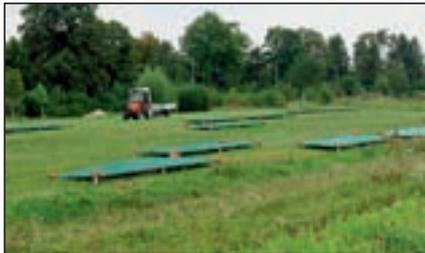
Abbildung 15: Schotterrasen-Versuchsfelder in Wien-Essling nach 3 Versuchsperioden mit Beschattungsvorrichtungen, September 2009 (SCHLAGER 2010)
