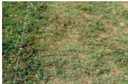
Abbildung 2: Blumenrasen im Versuchsgarten Wien-Essling nach 3 Jahren (2001); links unbelastet, rechts 1 x wöchentlich mit der Scherstollenwalze belastet
