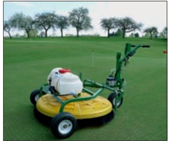
Abb. 9: ENVIROMIST Grünsspritze zur Ausbringung feinsten Tröpfchen (CDA-Technik) bei gleichzeitiger Vermeidung von Abdrift
