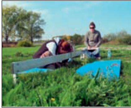
Abbildung 7: Messlatte (Line-Point-Methode) des Institutes für Ingenieurbiologie und Landschaftsbau, Forschungsprojekt GREEN CONCRETE
