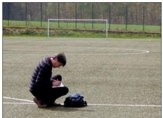
Abb. 7: Kritische Prüfung des Belages des Kunststoffplatzes bezüglich Granulatverfüllung und Florlänge im Trainingsgelände der Sportschule Hennef
