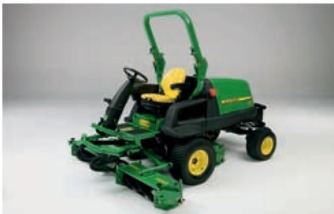
Der brandneue 8400 Spindelmäher von John Deere wurde speziell für die Bedürfnisse auf dem europäischen Markt entwickelt. Die mit einem leistungsstarken Dieselmotor (37 PS) mit Turbolader und kraftstoffsparender Direkteinspritzanlage ausgerüstete Maschine zeichnet sich durch hohe Flächenleistung, Steigfähigkeit und hervorragende Schnittbildqualität aus.
