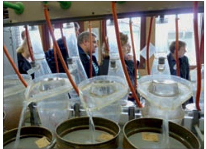
Abb.4: Vor der Auszählung von Boden-Nematoden erfolgt die Ausschwemmung über geeignete Siebe im Labor
