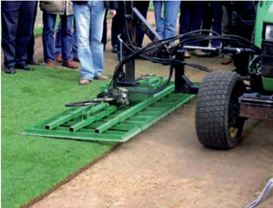
Spezielles Verlegegerät zum fugenfreien Verlegen von Dicksoden bei Peiffer Fertigrasen
