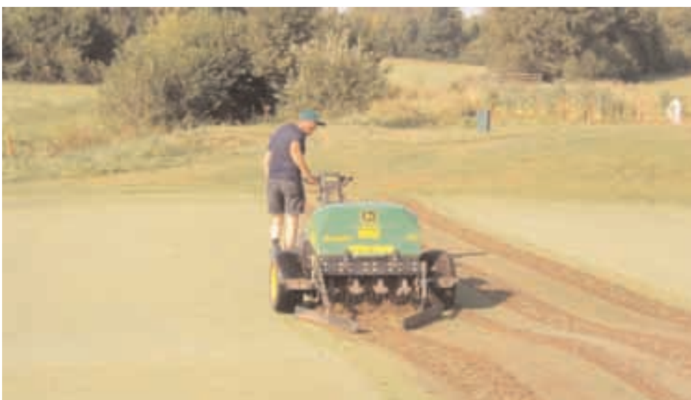
Bild 2: Aerifizieren eines Golfgrüns
