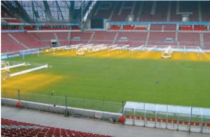
Foto 3: Mobile Beleuchtungsanlagen im PSV-Stadion. 10 Einheiten decken etwa 3.600 m 2 ab. Foto: Nonn
