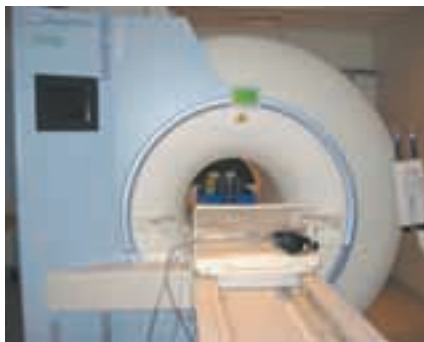
Abb. 1: Der Kernspintomograph „Magnetom Sonata“ der Fa. Siemens am Klinikum rechts der Isar der TU München. Die Magnetspule erzeugt im Inneren der Öffnung ein starkes Magnetfeld. Hier sind im Hintergrund Zylinderproben auf dem Patiententisch erkennbar.
