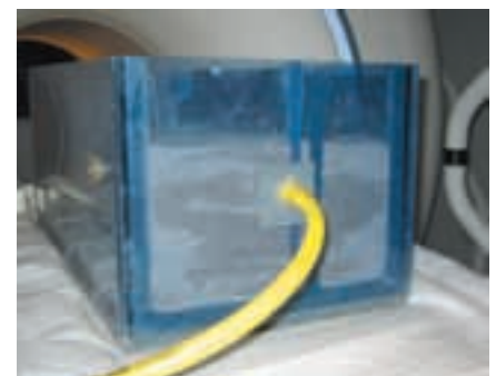
Abb. 5: Queransicht einer großvolumigen Probe von 60*40*25 cm Größe nach einem Bewässerungsversuch mit einem mittig eingebauten Membranschlauch der Fa. OSMO DRAIN. Die Wasserausbreitung tritt deutlich durch einen dunkleren Farbton hervor.
