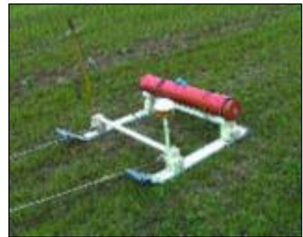
Bild 3: Kunststoffschlitten zur Erfassung der Leitfähigkeit mit GPS
