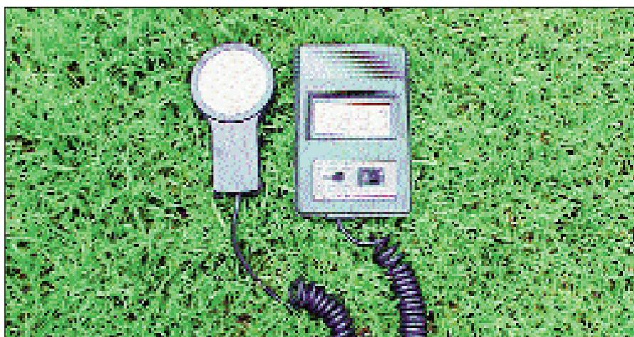
Abbildung 2: Messung der Beleuchtungsstärke mit einem Luxmeter (Foto: Nonn)
