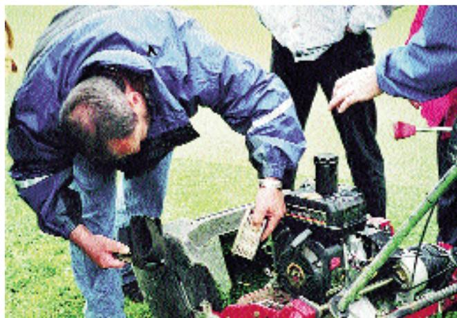
Bei Inbetriebnahme jeder Maschine gehört die WOLKE zur routinemäßigen Kontrolle. Hier: Das Reinigen des Luftfilters.
