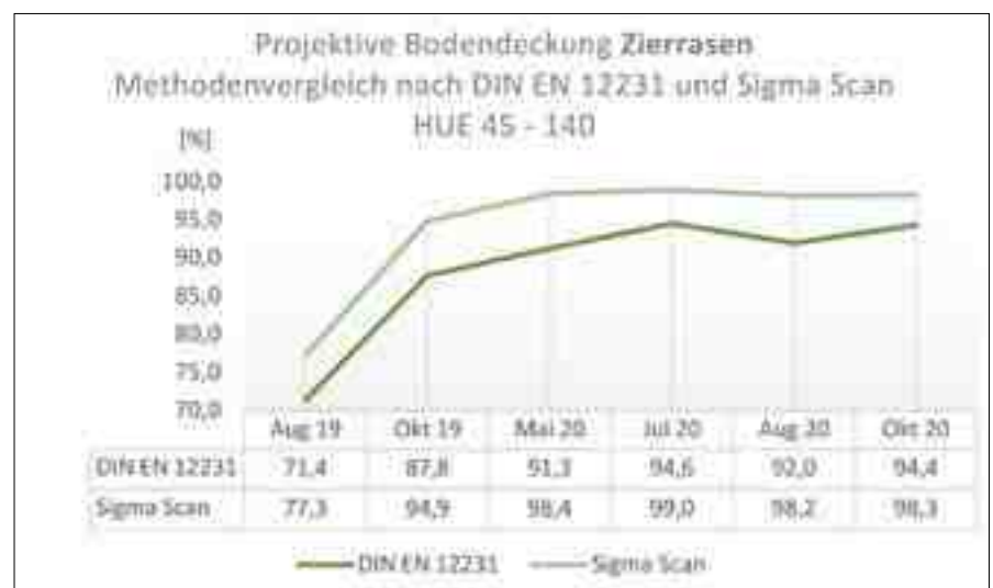
Abb. 7: Verlauf der projektiven Bodendeckung Zierrasen nach DIN EN 12231 und SigmaScan Hue 45-140.
