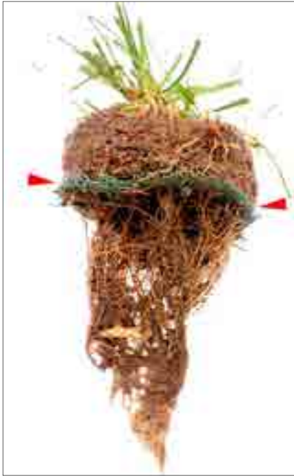
Abb. 3: Durchwurzelung eines Gewebes, Maschenweite 0,8 mm x 0,8 mm.
