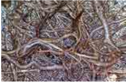
Abb 2: Durchwurzeltetes Spinnvlies, Öffnungsweite des Wirrgeleges 0,3 mm bis 0,5 mm, 200fach vergrößert.
