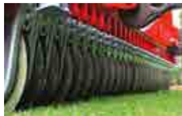
Overseeder mit gefederten Doppelscheiben, 140/180/240 cm
