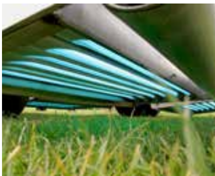
Abb. 2 und 3 (li. bzw. re.): UVC TurfCare Lichtmodule von unten, die bei Umgebungstemperaturen von 5-30 °C keinen Leistungsverlust haben wie die übrigen UVC-Lampen, die weitaus höhere Temperaturen für optimale Wirksamkeit benötigen.
