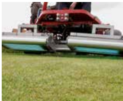
Abb. 2 und 3 (li. bzw. re.): UVC TurfCare Lichtmodule von unten, die bei Umgebungstemperaturen von 5-30 °C keinen Leistungsverlust haben wie die übrigen UVC-Lampen, die weitaus höhere Temperaturen für optimale Wirksamkeit benötigen.
