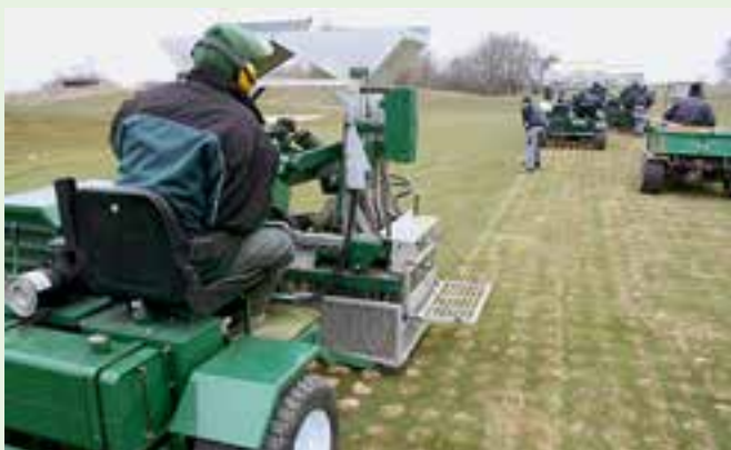
Der Ecosol Drill n Fill-Belüfter in der Praxis, hier auf der Anlage des GC Rheinhessen
