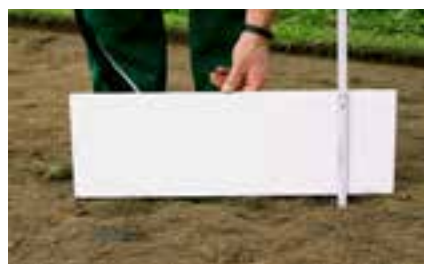
Abb. 9: Unebenheiten nach dem Abfräsen der Hybrid-Tragschichtvarianten. Texturierte Fasern neigen bei entsprechender Arbeitstiefe zur erhöhten Unebenheit.
