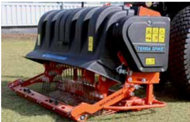
Der Terra Spike von Wiedenmann: Bis zu 40 cm lange Zinken arbeiten Luftkanäle in den Boden ein, damit sich die Rasenwurzeln besser entfalten und Staunässe verhindert wird. (Foto: Wiedenmann)
