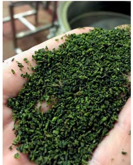
**Abb. 6-8:** Für die Granulatproduktion wird mehrfach zerkleinert und gesiebt, anschließend schonend getrocknet.
