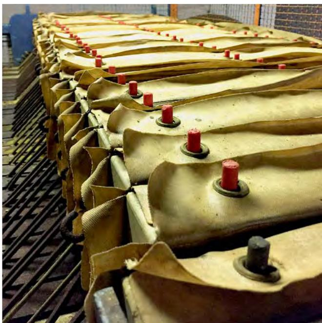
**Abb. 5: Durch aneinandergereihte Filter wird das Wasser-Algengemisch weiter aufbereitet.**
