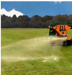
Das RINK-Eintellerstreuwerk eignet sich perfekt zum feinen, aber auch kräftigen Besanden. Beim Standardstreuwerk wird das Streugut nach hinten ausgeworfen. Mit dem Eintellerstreuwerk kann das Streumaterial sowohl seitlich als auch nach hinten ausgebracht werden. Durch Verdrehen des Leitbleches wird die Streurichtung flexibel eingestellt.
