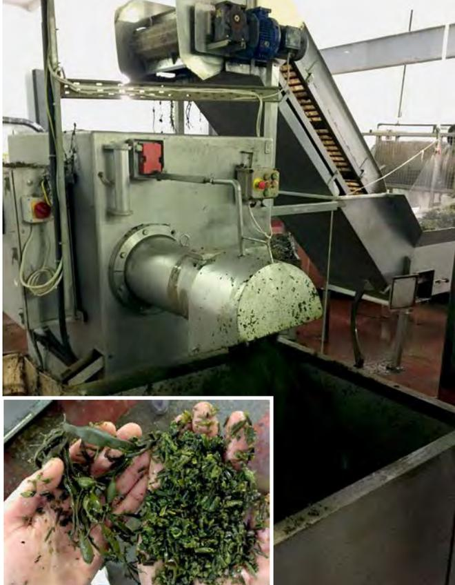
**Abb. 3: Reinigung, Sortierung und Zerkleinerung des Ausgangsmaterials.**
