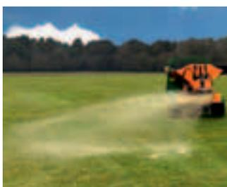
Das **RINK**-Eintellerstreuwerk eignet sich perfekt zum feinen, aber auch kräftigen Besanden. Beim Standardstreuwerk wird das Streugut nach hinten ausgeworfen. Mit dem Eintellerstreuwerk kann das Streumaterial sowohl seitlich als auch nach hinten ausgebracht werden. Durch Verdrehen des Leitbleches wird die Streurichtung flexibel eingestellt.
