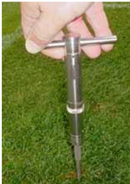
Abb. 3: Scherfestigkeitsmessung mit einer Flügelsonde.
