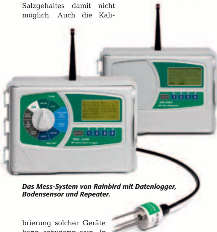
**Das Mess-System von Rainbird mit Datenlogger, Bodensensor und Repeater.**
