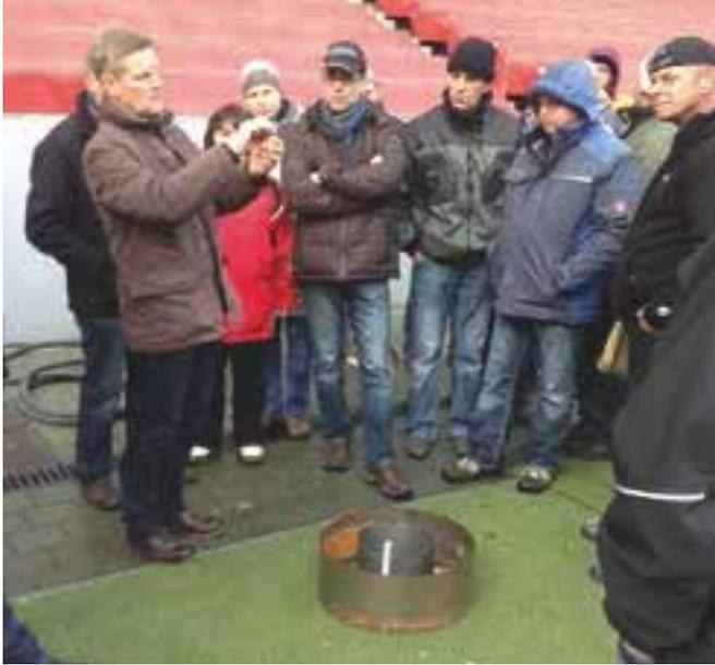
**Dr. Nonn bei der Erläuterung des Doppelring-Infiltrometers.**
