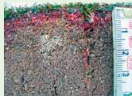
Abb. 7: Eingefärbtes Öl dringt in den Boden ein.
