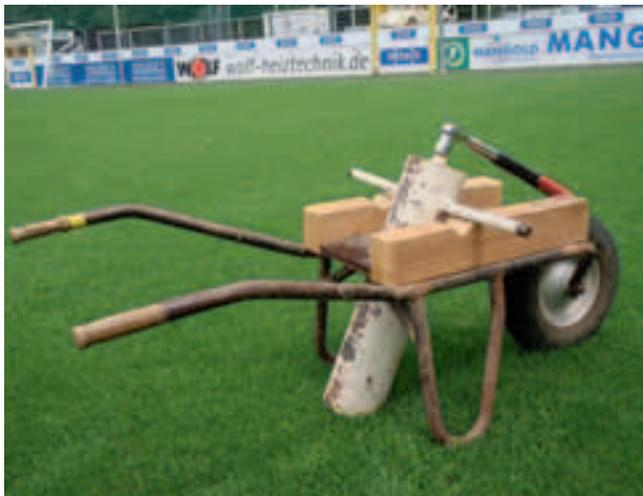
Abb. 2: Stollenschergerät mit aufgesetztem Drehmomentschlüssel. Scholz-Arena Aalen, 15.7.2010.
