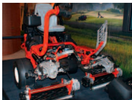
Abb. 8: Der neue Hybridgrünsmäher 3320 der Fa. Toro mit geänderter Einheitenanordnung
