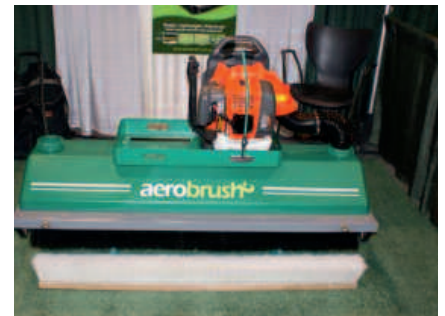
Abb. 3: Das Anbaugerät Aerobrush zum Einarbeiten von Sand in die Aerifizierlöcher
