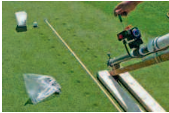
Abb. 2: Pneumatisches Ausstoßgewehr zur Erstellung von „Ball Mark“,
