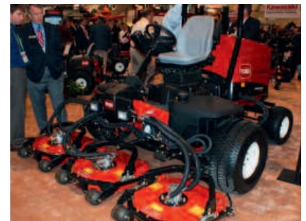
Abb. 9: Der Groundmaster 4300 von Toro ist der leichte Bruder des GM 4500 mit kleineren Einheiten
