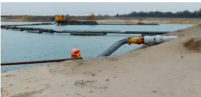
Abb. 1: Saugbagger zur Förderung des Quarzsandvorkommens in der Lagerstätte Marx-Barge
