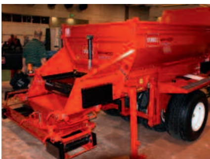
Abb. 7: Der Großflächenbesander mit Verfüllvorrichtung MH 400 der Fa. Toro ist einer von drei neuen Besander
