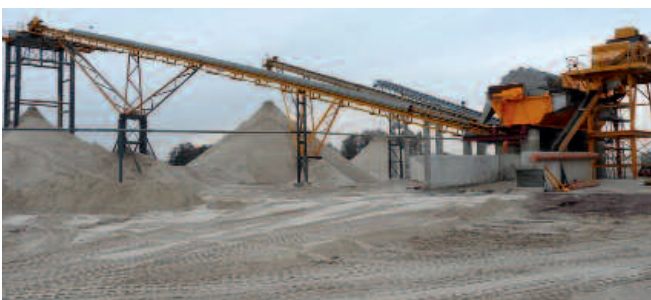
Abb. 3: Schöpfradanlage mit Förderbändern zur Basis-Trennung der Sandfraktion
