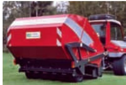
**Kehren und Aufsammeln:** Durch das Doppelkehr-Bürstensystem und die patentierte Luftleitführung ist das saubere Aufnehmen von schwierigem Kehrgut kein Problem.
