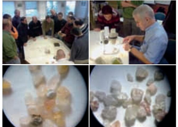
*Oben links: Dr. Mehnert in seinem Element; oben rechts: Dr. Speakman am Mikroskop. Unten links: Sand kantengerundet, unten rechts: Sand scharfkantig gebrochen)*
