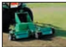
Graden Swing Wing schlepperangetriebener Scarifier. Ermöglicht das Eindringen von Luft, Wasser, und Topdressing durch den Filz bis hin zur Wurzelzone.
